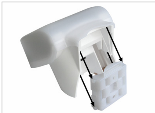
Abb. 10 Schieben Sie das Gehäuse von oben in den montierten Halter. Die Zapfen des Halters müssen dabei in den Schienen des Gehäuses einrasten.
