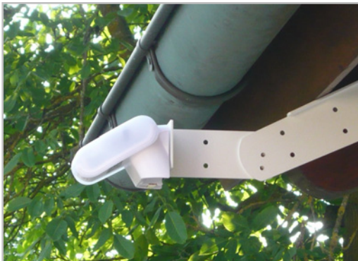
Abb. 7: Durch den Gelenk-Ausleger schaut der Sensor unter dem Dachvorsprung hervor. Sonne kann ungehindert erfasst werden.
