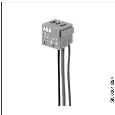
Die EIB-Geräte sind intern gegen Überspannungsimpulse bis 2 kV (1,2/50) geschützt. Um sie darüber hinaus zu schützen, wird der Überspannungsschutz verwendet. Er besitzt die Form einer einteiligen blauen Busklemme mit drei fest angeschlossenen Adern.
