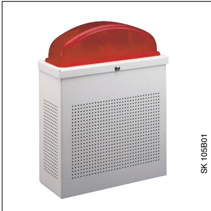
Der Signalgeber SSF/GB dienen zur örtlichen externen Alarmierung durch Einbruchmeldeanlagen. Der Signalgeber entspricht den VdS-Richtlinien der VdS-Klasse C. Der akustische Alarmteil besteht aus einem Tongenerator mit Leistungsverstärker und Lautsprecher. Der Signalgeber SSF/GB verfügt zusätzlich über eine optische Alarmierung durch eine Blitzleuchte. Das Gehäuse besteht aus pulverbeschichtetem rostfreiem Aluminium. Zur Sabotageüberwachung ist ein Deckelkontakt eingebaut.
