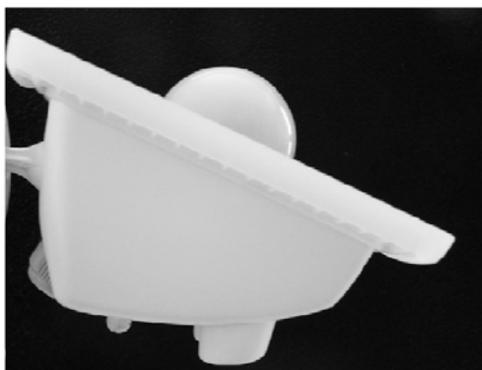
Der Außentemperaturfühler ist am Gehäuse angeklebt und die Anschlussdrähte des Fühlers werden durch eine Bohrung in das Gehäuseinnere zur Elektronik geführt. Durch starkes Drücken oder Drehen des Fühlers können die Anschlussdrähte abbrechen und die Temperaturmessung funktioniert nicht mehr ordnungsgemäß.
