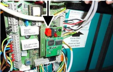
4. K-SM-Steckmodul vorsichtig, bis zum vollständigen Einrasten der Abstandsbohlen, auf Steckplatz X01 der Hauptplatte aufstecken – alle Abstandsbohlen korrekt einstecken.
