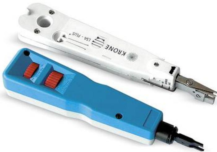
Auflegewerkzeuge für LSA-Plus-Schneidklemmkontakte
