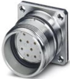
Gerätesteckverbinder Vorderwand, gerade, geschirmt: ja, Schraubverriegelung, M23, Polzahl: 12, Kontaktart: Buchse, Lötanschluss, Flachdichtung, 4x Ø3,2
