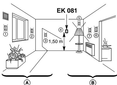
installer la sonde à 1,50 m du sol, sur le mur intérieur ④ en évitant les influences externes : (① aérateur, ② mur extérieur, ③ rayons de soleil) et internes : (⑤ appareil d'éclairage, ⑥ derrière conduit de fumée, four ⑦ convecteurs)
