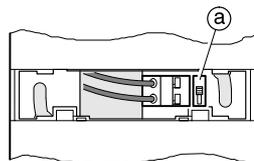
en association avec le thermostat EK 186 et le régulateur EK 286 : commutateur (a) en position haute ; mesure aux bornes d'une CTN de 10 kΩ à 25 °C
