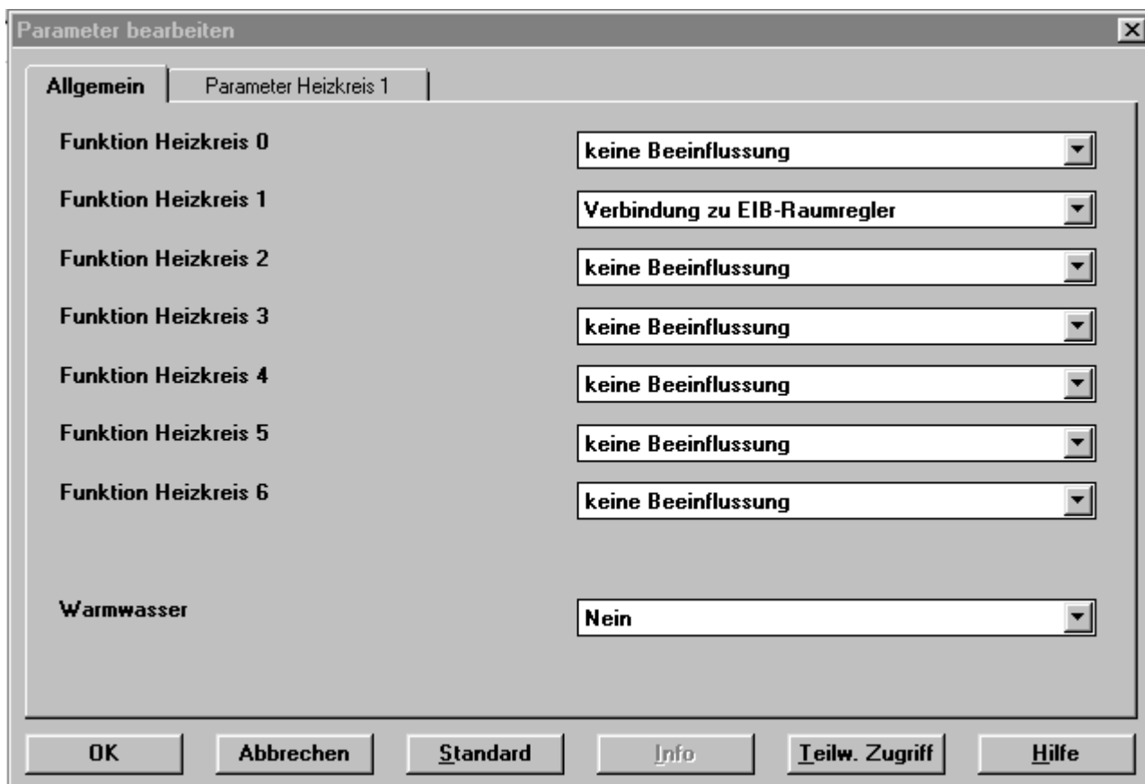
Abbildung 2: Parametermenü des FM446 mit einer gewählten Beeinflussung des Heizkreises 1
